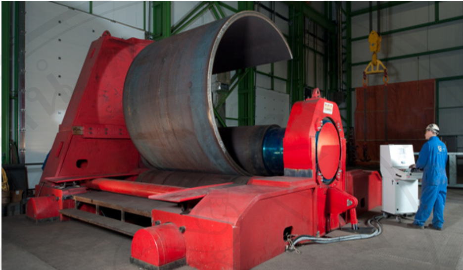
ภาพที่ 2.10 แสดงการขึ้นรูปวัตถุดิบด้วยเครื่องม้วน
