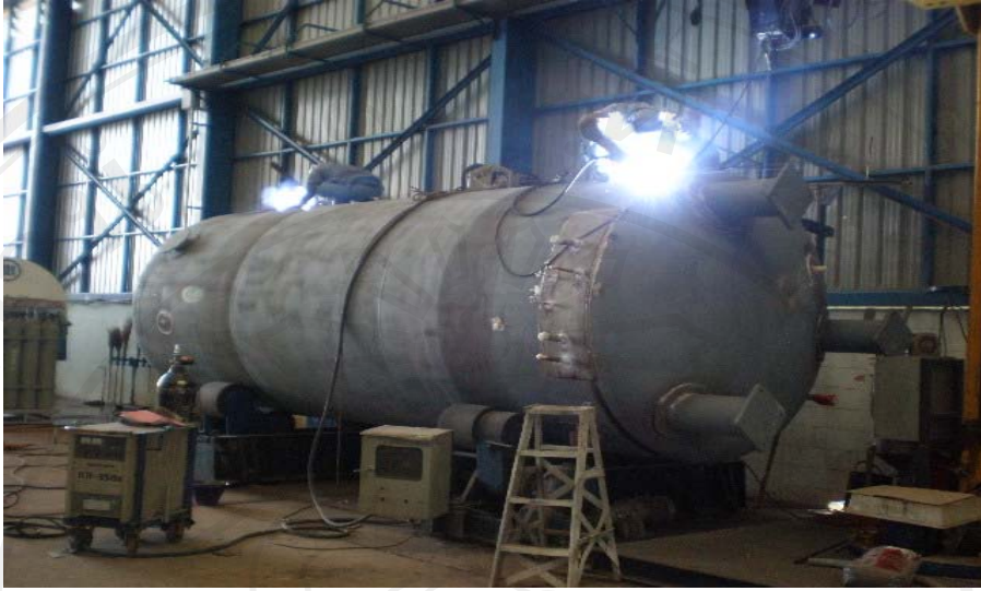
ภาพที่ 2.15 แสดงการเชื่อมถังบนแท่นหมุนงาน
