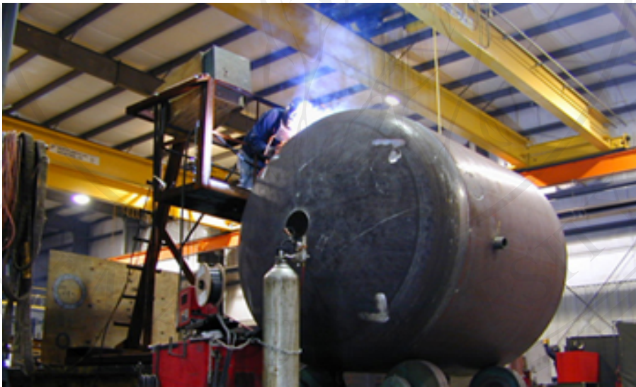
ภาพที่ 2.16 แสดงการเชื่อมถังโดยใช้เครื่องแขนกลช่วยเชื่อมและเครน
