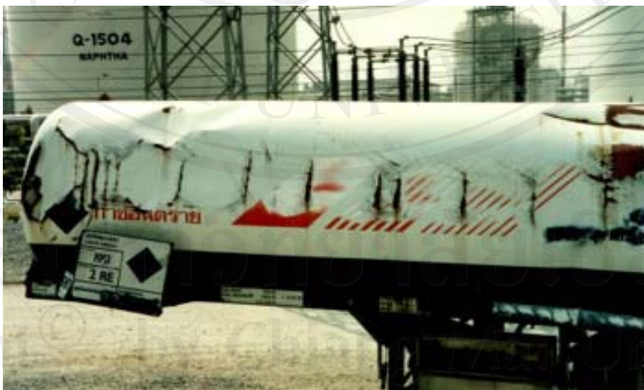
ภาพที่ 2.21 ถังขนส่งก๊าซเหลวเกิดอุบัติเหตุพลิกคว่ำ
