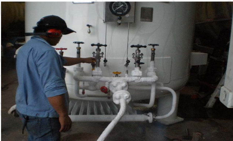
ภาพที่ 2.19 การทดสอบค่าสุญญากาศให้ได้ค่าคงที่ และเตรียมส่งให้ลูกค้า
