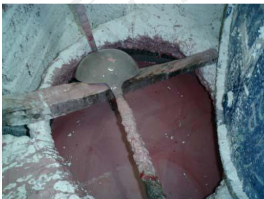
ภาพที่ 2-1 การผสมเรซินในภาชนะผสม โดยผสมตัวม่วง น้ำยาขาวและแป้งแคลเซียมตามอัตราส่วนที่เหมาะสม
