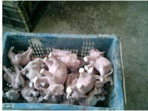
ภาพที่ 2-6 ผลิตภัณฑ์ที่เจียรเสร็จ พื้นผิวจะเรียบ สามารถตั้งตรงได้ แลดูสวยงามขึ้น
