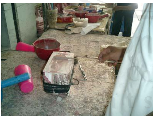
ภาพที่ 2-3 การหล่อเรซินลงบล็อก เทน้ำยาที่ผสมลงในบล็อกที่เตรียมไว้ แล้วปิดบล็อกเพื่อให้แห้ง
