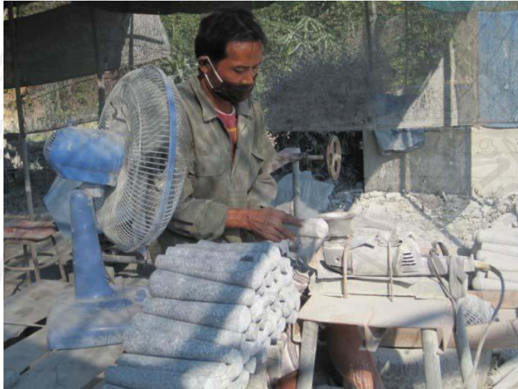
ภาพที่ 41 เข้าเครื่องเจียรหัวท้ายซากเพื่อทำการตกแต่ง
