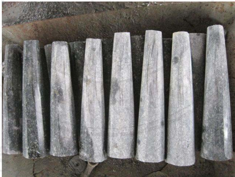
ภาพที่ 38 หุ่นสากที่ได้ตัดหัวท้ายและเหลาเหลียมแล้ว
