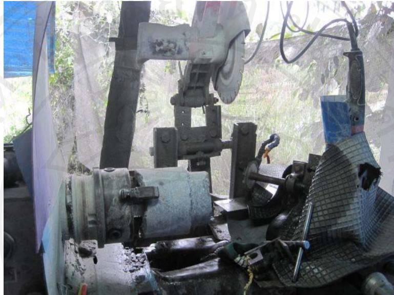
ภาพที่ 18 นำหุ่นครกรูปทรงกระบอกใส่เครื่องกลึง
