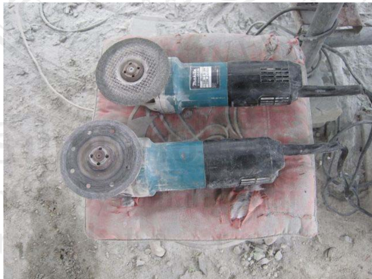
ภาพที่ 28 เครื่องเจียรไฟฟ้า ขนาด 4 นิ้ว
