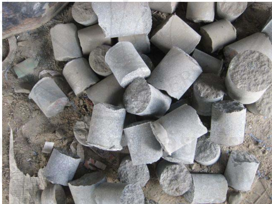
ภาพที่ 2 ภาพหุ่นครกขนาด 3 นิ้วที่ได้จากการเจาะหุ่นครกขนาด 6 นิ้ว
