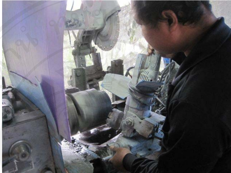
ภาพที่ 20 นำหุ่นครกเข้าเครื่องกลึงใช้เครื่องเจียรทำเอวครก
