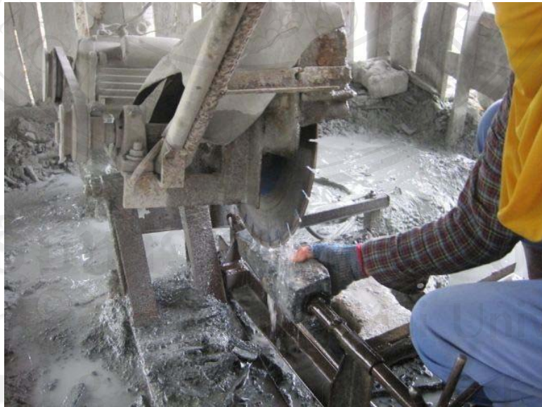
ภาพที่ 36 ตัดหัวท้ายและเหลาเหลี่ยม
