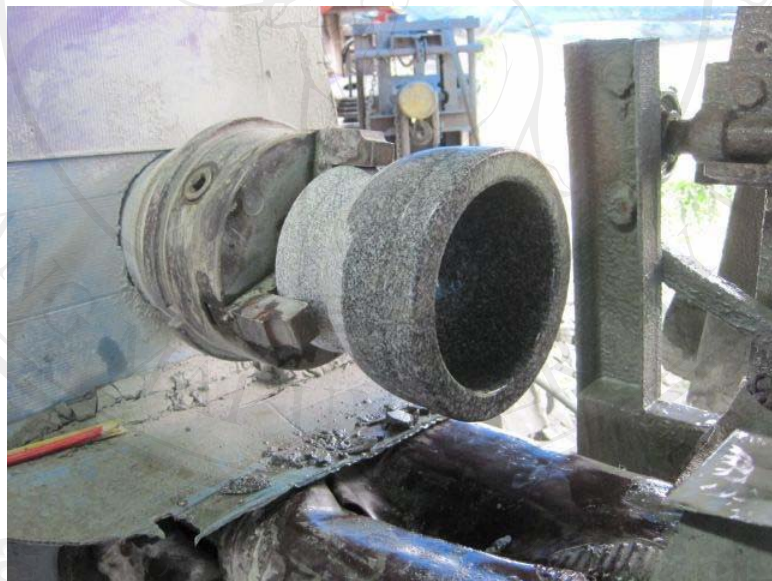
ภาพที่ 23 ภายหลังทำหลุมในครกแล้ว
