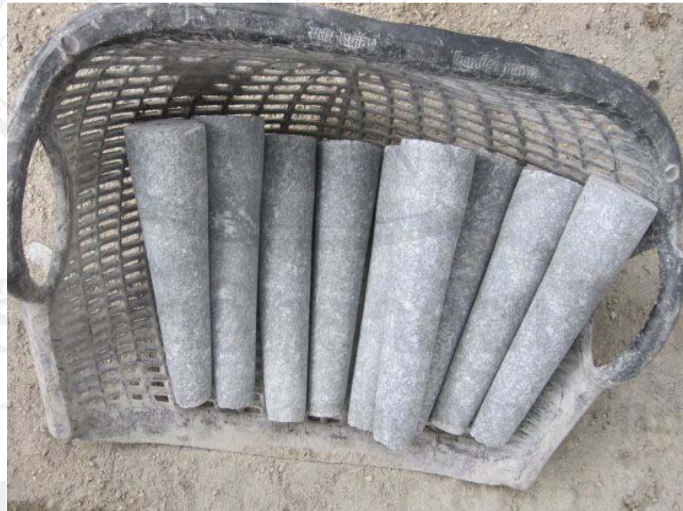
ภาพที่ 40 หุ่นสากที่ได้หลังจากเจียรลบเหลี่ยมแล้ว
