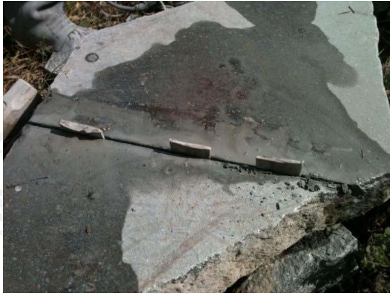
ภาพที่ 33 เอลิมยัดในร่องจากน้ำให้ค้อนตอก
