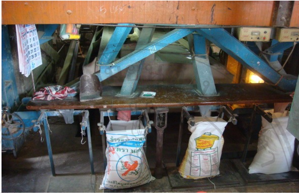
ภาพที่ 18 แสดงการบรรจุข้าวสารด้วยเครื่องชั่งแบบกึ่งอัตโนมัติ ปริมาณบรรจุ 50 กิโลกรัม
