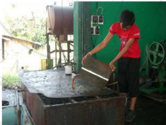
ภาพที่ 4.6 นำน้ำมันพืชเก่าที่รับซื้อมาเทลงถังอุ่นน้ำมัน
