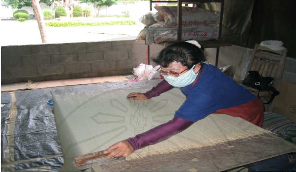
ภาพที่ 4.9 การตัดแต่งและตรวจสอบคุณภาพของเนื้อเสื่อหลังการทอเสร็จเรียบร้อยแล้ว
