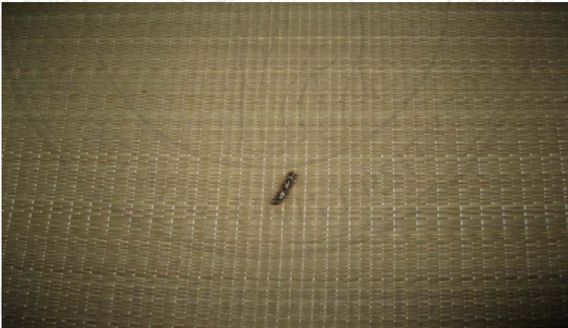
ภาพที่ 4.28 แสดงรอยขีดข่วนเป็นรอยไหม้จากความร้อนของเครื่องจักรที่ใช้ในการผลิต
