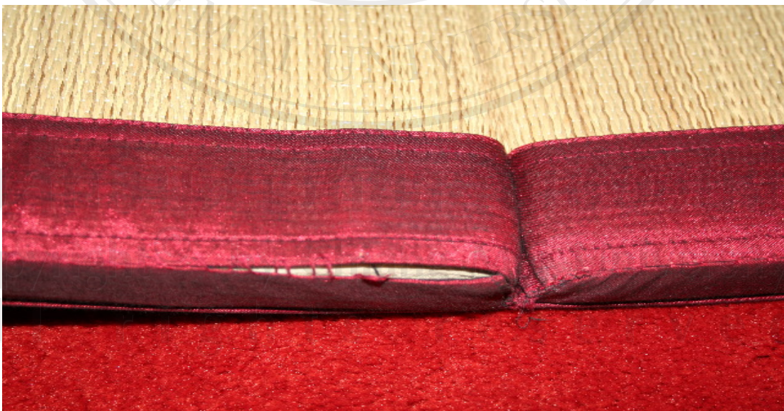
ภาพที่ 4.30 แสดงการเย็บขอบเสื้อที่ไม่ได้มาตรฐาน
