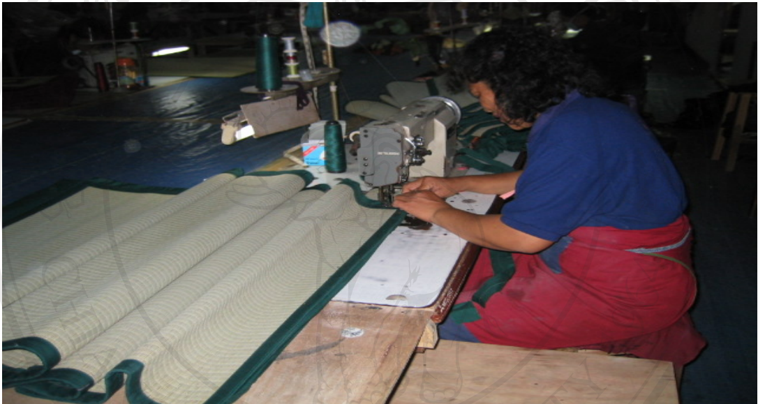
ภาพที่ 4.17 การเย็บขอบเลื้อด้วยผ้า
