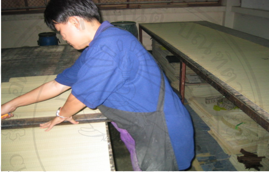
ภาพที่ 4.14 การตัดเสื่อตรงจุดตัดด้วยใบมีด
