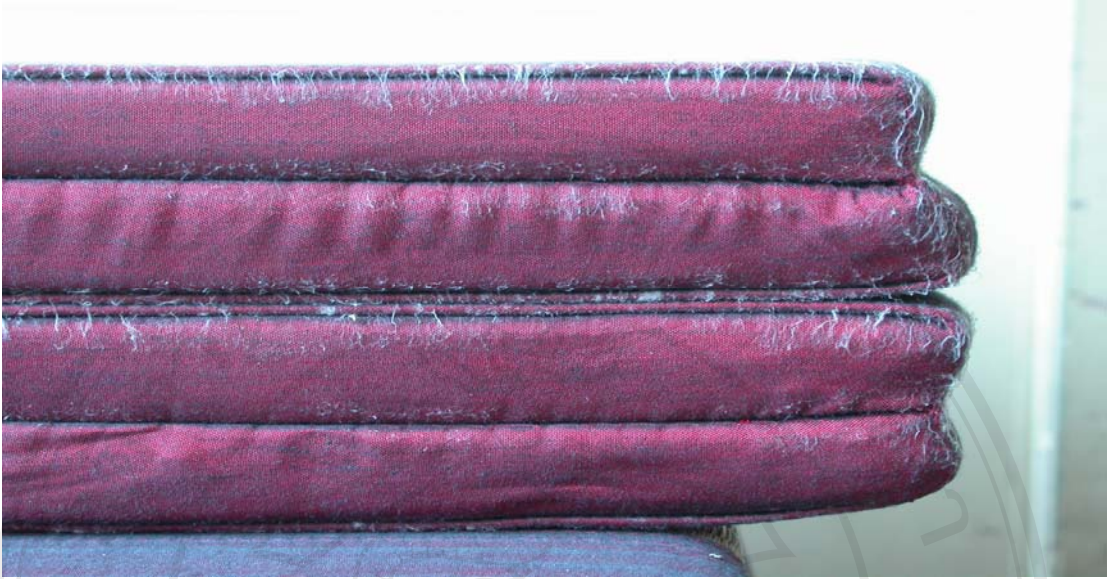
ภาพที่ 4.26 แสดงเชื่อร่าจับที่สินค้าเนื่องจากความชื้น
