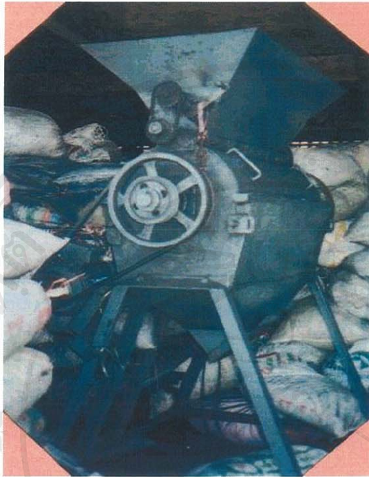
รูปที่ 4.6 เครื่องบดขังข้าวโพดให้เป็นผงคาร์บอน
