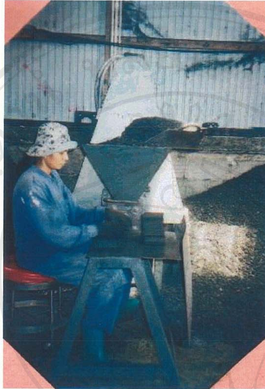
รูปที่ 4.8 เครื่องอัดแท่งถ่านจากซังข้าวโพด
