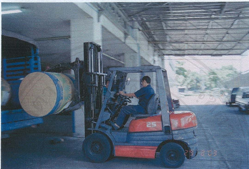
รูปที่ 4.31 แสดงการหนีบกระดาษลงจากรถบรรทุกกระดาษ ที่เป็นแบบเปิดกระเบทำด้านเดียว
