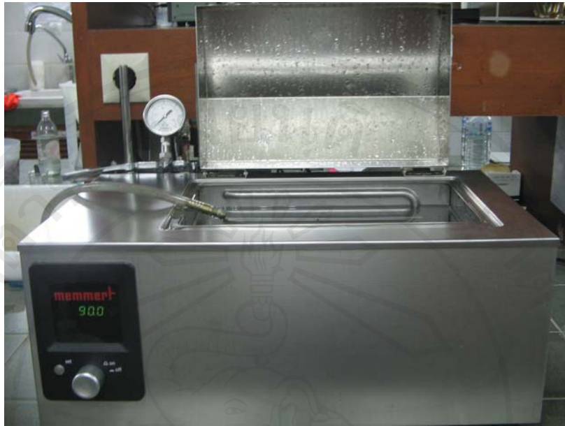
ภาพที่ ก.5 ชุดล้างขวดด้วยน้ำร้อนระดับห้องปฏิบัติการ คัดแปลงจากอ่างน้ำควบคุมอุณหภูมิต่อด้วย ปั๊มปรับระดับแรงดัน ฟังสายฉีดน้ำ
