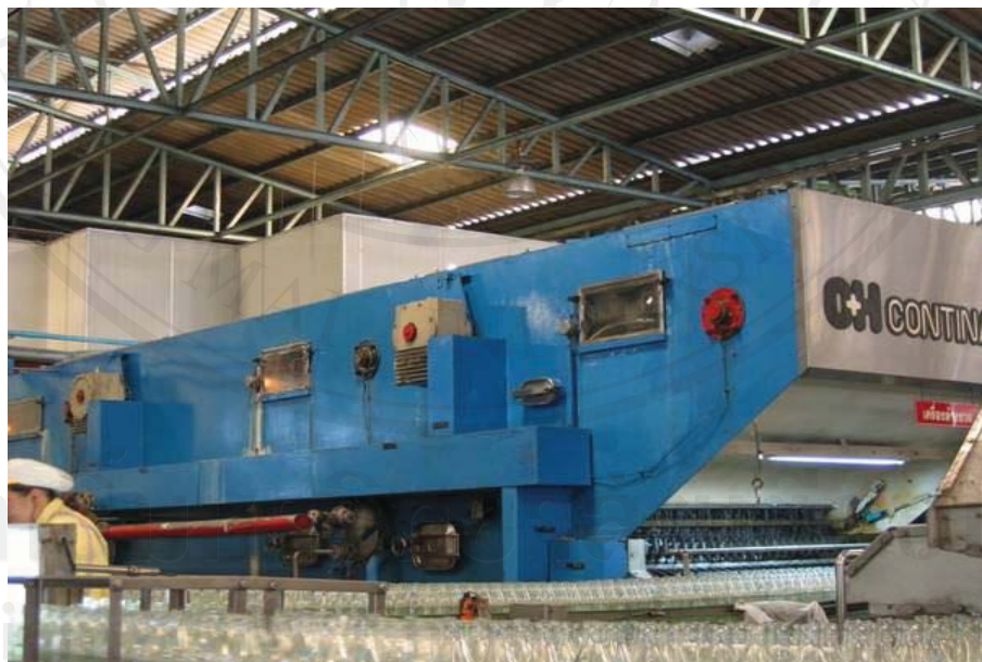
ภาพที่ ก.3 เครื่องล้างขวดอัตโนมัติระดับอุตสาหกรรม ที่ใช้ในงานวิจัย
