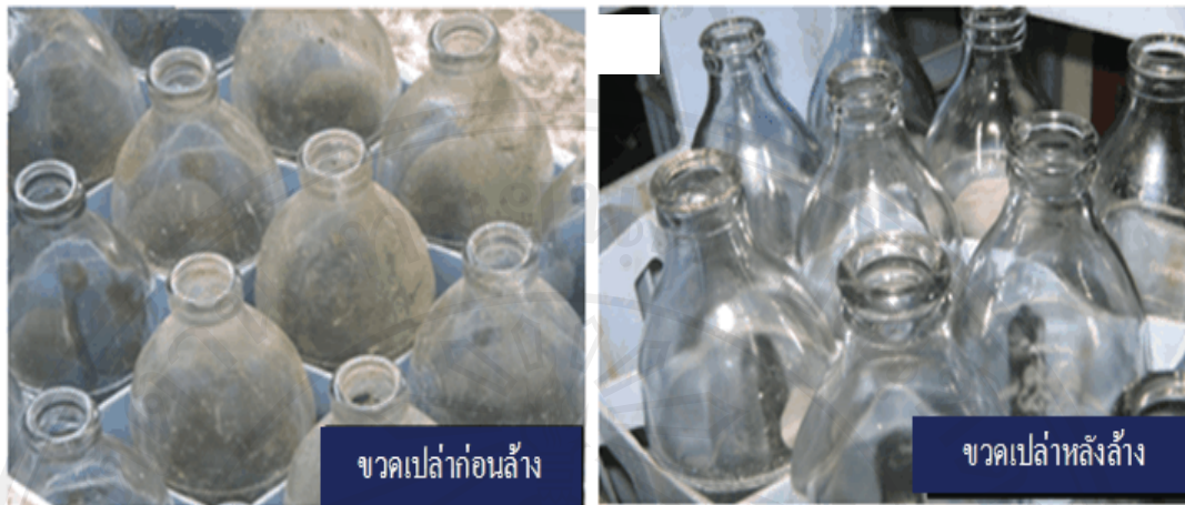
ภาพที่ ก.2 ลักษณะขวดเปล่าที่ใช้แล้วเปรียบเทียบกับก่อนและหลังผ่านกระบวนการล้างภายใต้สภาวะปกติของโรงงาน
