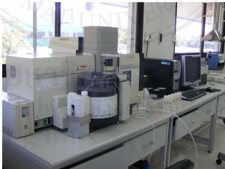
รูป ก-2 เครื่อง Flame AAS ยี่ห้อ SHIMADZU รุ่น AA-6300
