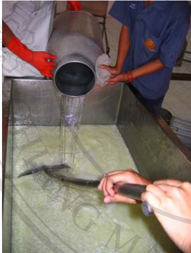
ภาพ ก-15 ปรับอุณหภูมิเป็น 38 °C ด้วยน้ำร้อน
