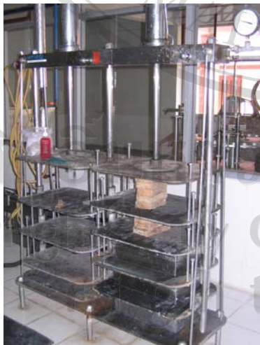
ภาพ ก-23 อัดเคิร์ดในพิมพ์ด้วยความดัน 5 บาร์ 60 นาที
