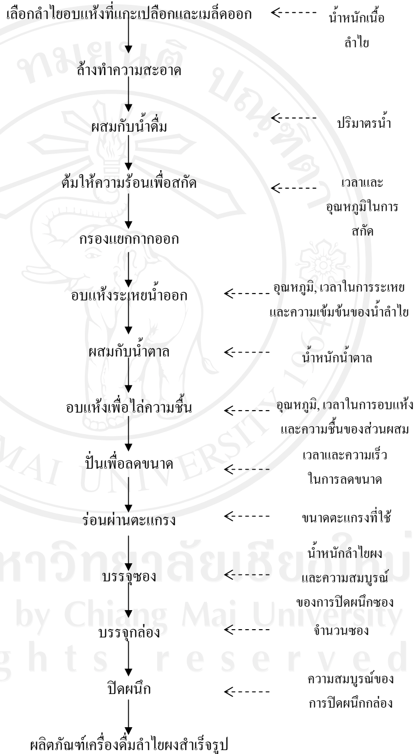
แผนภูมิที่ 4.5 ปัจจัยการควบคุมกระบวนการผลิตเครื่องตีผงลำไยสำเร็จรูป
