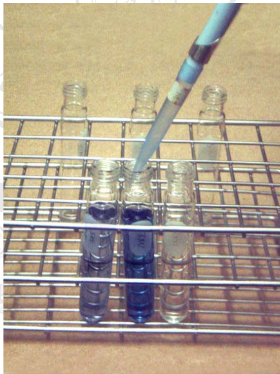
ภาพ ก 5 ขั้นตอนการทำให้เกิดสีโดยใช้ไอโอดีน
