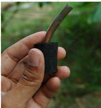
ภาพที่ 9 แสดงลักษณะการต่อจุกยางกับท่อทองเหลือง(ที่มา : Siamreptile (2553))
