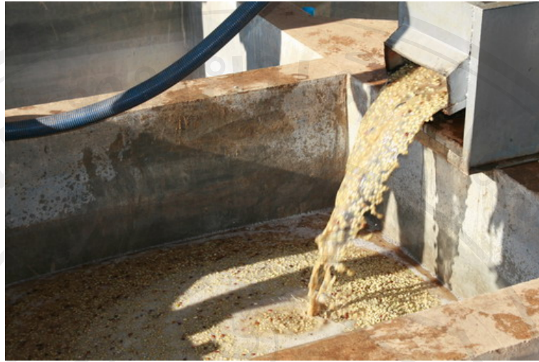
ภาพที่ 4 ผลกาแฟสุกที่ผ่านการโม่แล้วแช่น้ำในบ่อซีเมนต์
