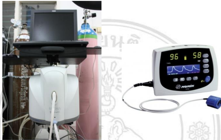
ภาพที่ 4 เครื่อง Med Graphic Gas Analyzer (USA) และเครื่องวัดชีพจร (Heart rate) และร้อยละความอิ่มตัวของออกซิเจนในเลือด (% Sat O_2 ) ด้วยเครื่องมือ Nonin® 9700 (USA)
