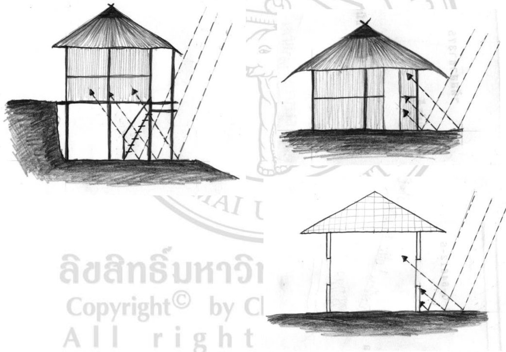
ภาพที่ 4.21 แสดงการสะท้อนของแสงธรรมชาติจากพื้นดินเข้าสู่พื้นที่ภายในเรือนรูปแบบต่างๆ ผ่านช่องแสง ภาพซ้ายบนเรือนผนังไม้ไผ่สานลายสองยกพื้นสูง ภาพขวาบนเรือนผนังไม้ไผ่ตีฟากพื้นติดดิน ภาพล่างเรือนผนังก่ออิฐฉาบปูน
