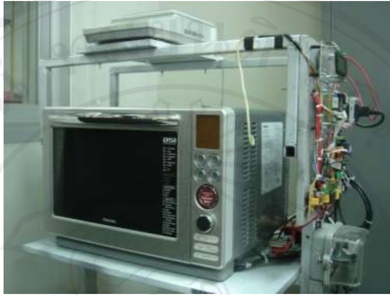
ภาพที่ ก.3 เครื่องอบไมโครเวฟที่ควบคุมอุณหภูมิได้
