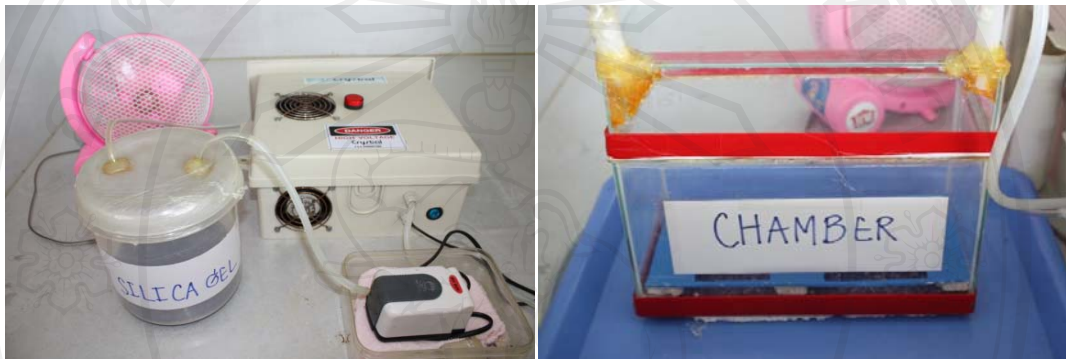
ภาพ 3.2 เครื่องผลิตโอโซน (ซ้าย) และภาชนะ (chamber) ที่บรรจุแมลงเพื่อรมก๊าซโอโซน (ขวา)
