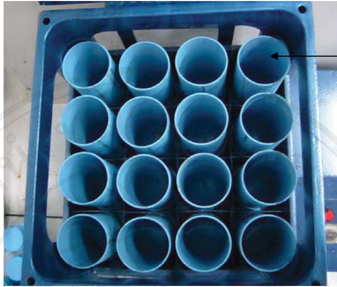
ภาพ 3.5 ช่องสำหรับใส่ตัวอย่างส้มในการจำลองการสั้นสะเทือน
