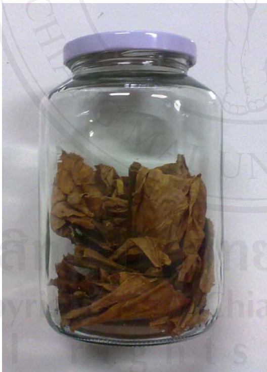
ภาพ 3.2 ขวดโหลแก้วมีฝาปิดเป็นตาข่ายถี่ ขนาดบรรจุ 500 มิลลิลิตร ที่บรรจุใบยาสูบแห้ง เวอร์ยีนีประมาณ 100 กรัม เพื่อใช้เลี้ยงแมลง (ซ้าย) ฝาปิดเป็นตาข่ายถี่ (ขวา)
