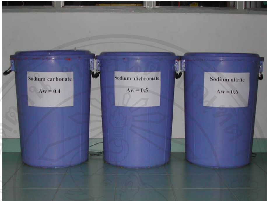
ภาพที่ 3.1 ถังปิดภายในบรรจุสารละลายเกลืออิมิตัวเพื่อปรับสภาพค่า a_w ของเนื้อลำไยอบแห้งที่ใช้ในการทดลอง
