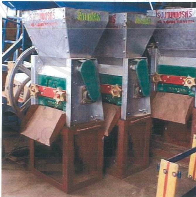
รูปที่ 2.9 เครื่องสีเปลือกสตกาแฟแบบทรงกระบอกแนวนอน ของบริษัท เพชรศรี
