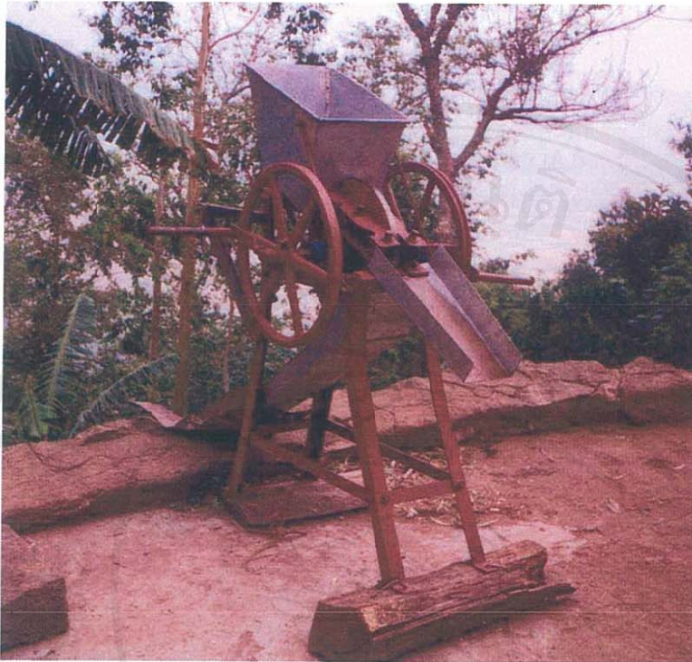
รูปที่ 2.6 เครื่องตีเปลือกสดกาแฟแบบลูกสีงานในอินเดีย (Sudhakar, 2000)
