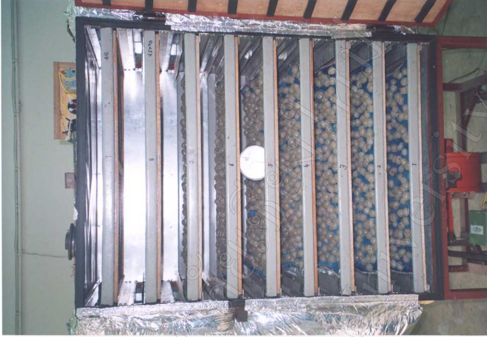
รูปผนวกที่ 6 ด้านในของห้องอบแห้งเมล็ดวางถาดบรรจุลำไย
