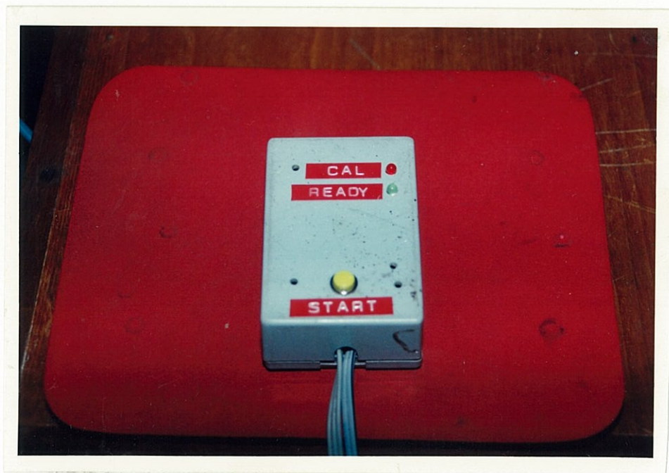
รูปที่ 50 ลักษณะของ Switch สั่งให้เครื่องคัดขนาดทำงาน
