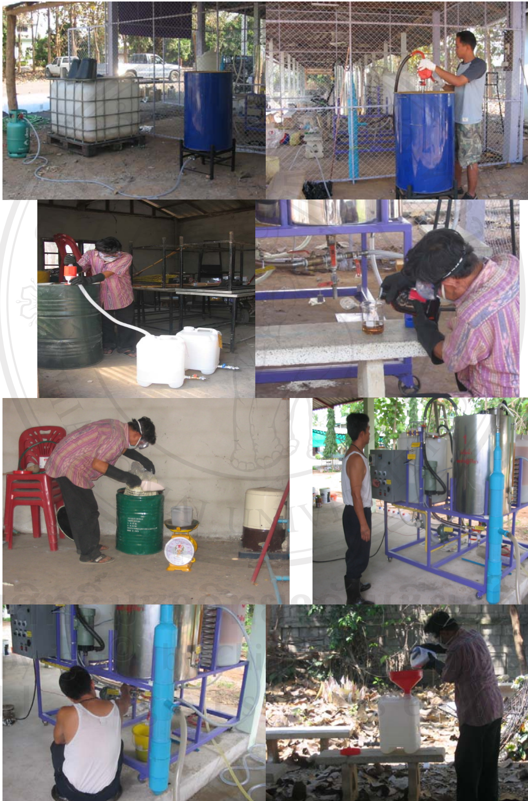
ภาพที่ 9 แสดงการดำเนินการผลิตไบโอเอทานอลในขั้นตอนต่างๆของเจ้าหน้าที่ผลิตไบโอเอทานอล
