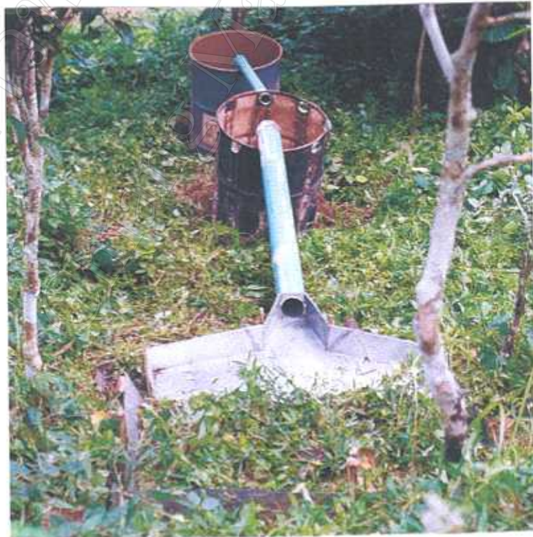
ภาพที่ 12 อุปกรณ์ตรวจวัดปริมาณตะกอนที่เกิดจากการชะล้างพังทลายของหน้าดิน
