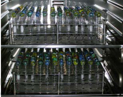
ภาพที่ ข8. การย่อยตัวอย่างปัสสาวะในตู้อบลมร้อนที่อุณหภูมิ 100 องศาเซลเซียส
