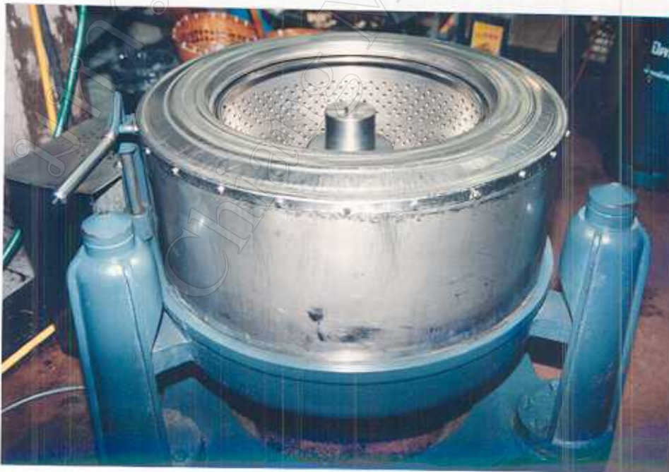
ภาพที่ 4 แสดงเครื่องแยกปริมาณน้ำมันตกค้างด้วยแรงหมุนเวียน ( Oil separating - centrifugal machine)
