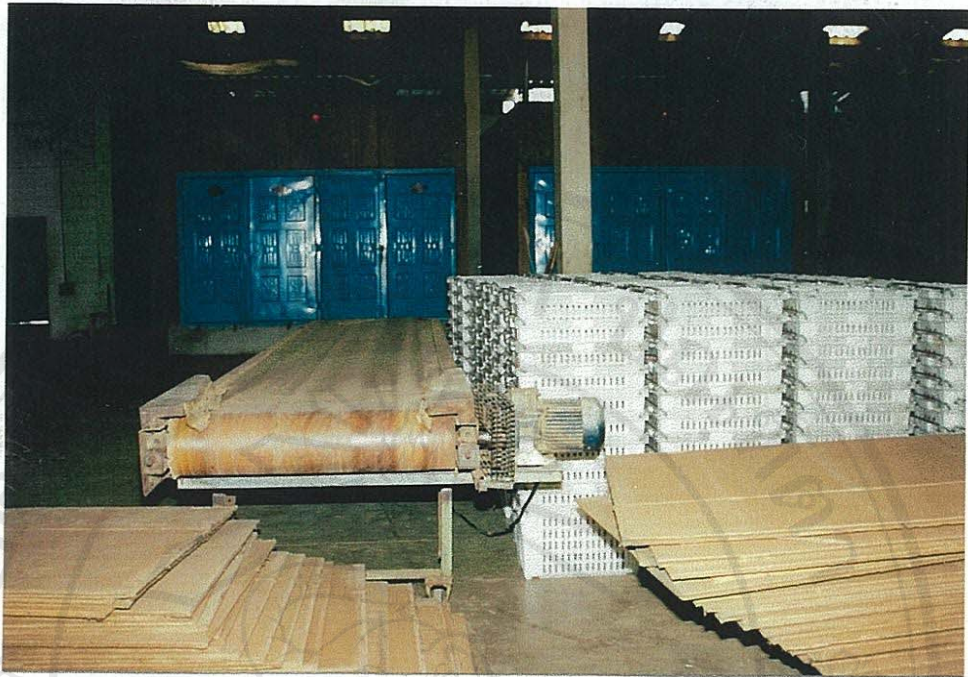
รูปที่ 3.10 ชุดสายพานลำเลียงวัตถุดิบเข้าเตาและภาชนะบรรจุลำไยก่อนเข้าเตาอบ
