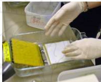
ภาพ 21 การย้ายโปรตีนมาใส่ในแผ่นไนโตรเซลลูโลส (แหล่งที่มาจาก mit.edu)
