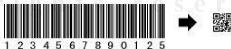
รูปที่ 2.3 เปรียบเทียบการเก็บข้อมูลจำนวนเท่ากันแต่ให้ขนาดเล็กกว่า
