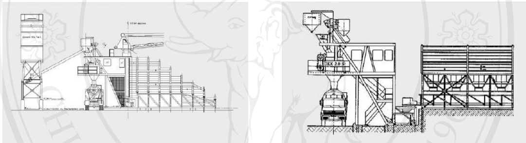
หิน ทราย ถูกลำเลียงเก็บไว้ใน Pocket ไซโล
