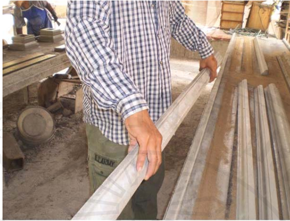
ภาพ 3.19 การยกชิ้นงานแบบตะแคงข้าง
