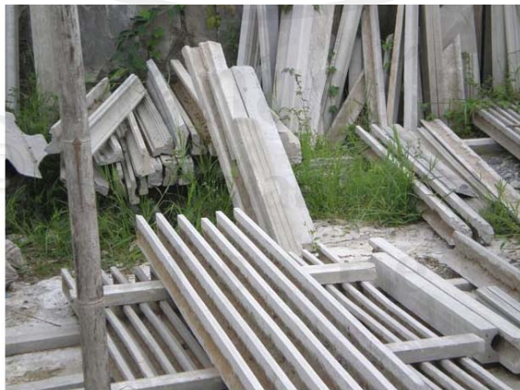
ภาพ 3.21 การกองเก็บชิ้นงานที่แห้งสนิทแล้ว
