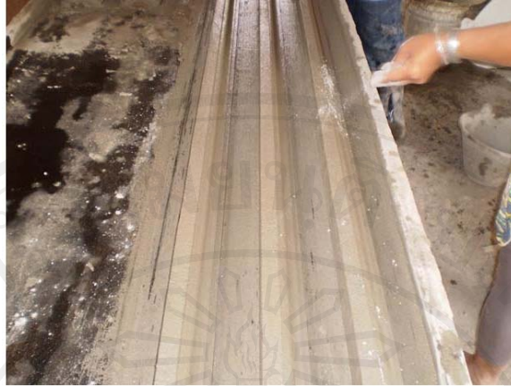
ภาพ 3.15 การโรยผงปูนเพื่อให้ชั้นงานหมาดเร็วขึ้น
