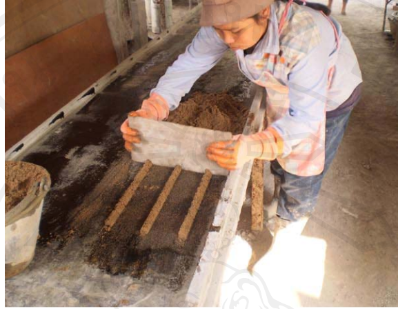
ภาพ 3.2 การขึ้นรูปฐานทรายด้วยกบ
