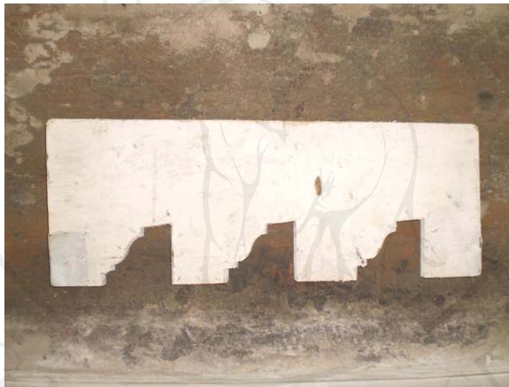
ภาพ 3.5 กบสำหรับขึ้นรูปบัว
