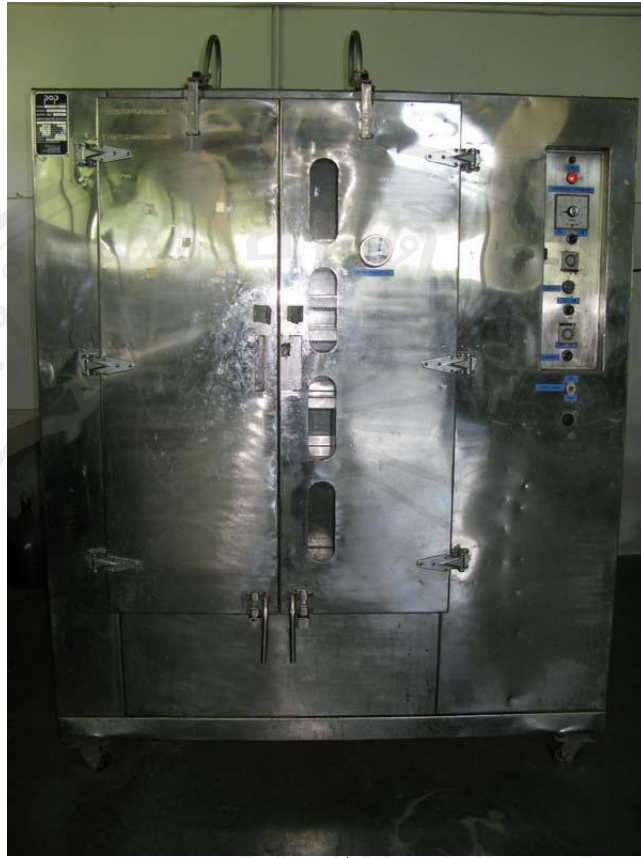
รูปที่ ก1 ตู้อบแห้งลิ้นจี่ (Tray dryer)
