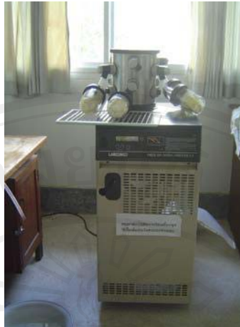
รูปที่ จ-4 : เครื่อง freeze dryer ที่ใช้อบแห้งแบบระเหิดนมผงแช่แข็ง
