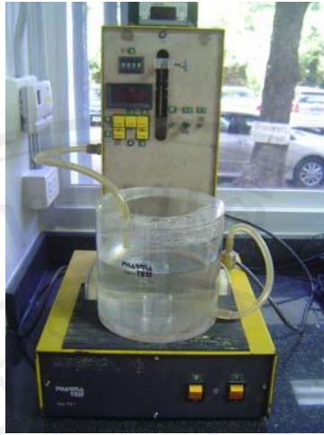
รูปที่ จ-10 : เครื่องวัดค่าการแตกตัวของนมผึ้งอัดเม็ด
