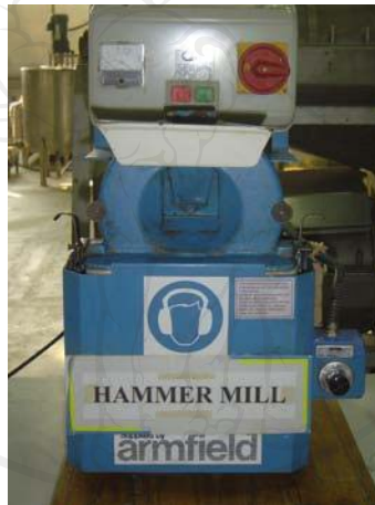
รูปที่ จ-5 : เครื่อง “Hammer mill” ที่ใช้ในการบดนมผงให้เป็นผง
