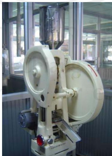
รูปที่ จ-12 : เครื่องอัดเม็ดแบบสากเดี่ยว (single punch tableting machine)
