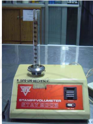
รูปที่ จ-7 : เครื่องเคาะผง Jolting volumeter
