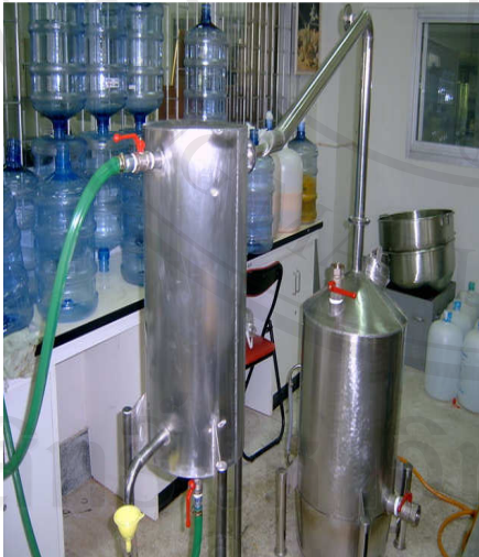
รูป ก-2 เครื่องกลั่นสุราแบบ pot still ที่ใช้ในงานวิจัย
