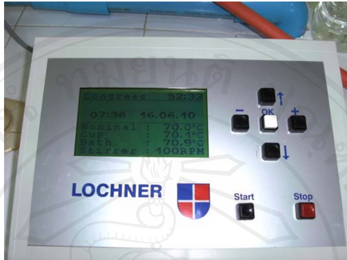
ภาพภาคผนวก 5 แผงควบคุมเครื่อง Mashing bath
