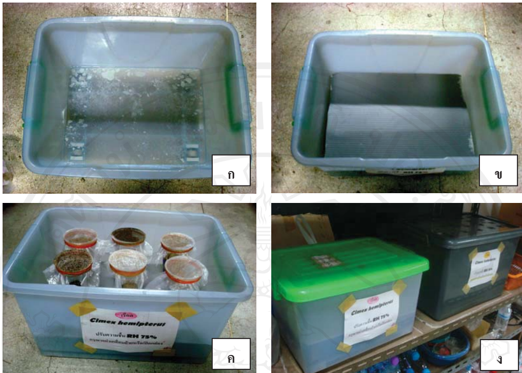
ภาพที่ 3.4 กล่องพลาสติกบรรจุสารละลายโซเดียมคลอไรด์ระดับสารละลายสูงประมาณ 5 เซนติเมตร จากพื้นกล่องที่ทำการปรับความชื้นสัมพัทธ์ 75 เปอร์เซ็นต์ (ก) นำแผ่นพลาสติกปูรองเพื่อสำหรับบรรจุแก้วเลี้ยงแมลง (ข) นำแก้วเลี้ยงแมลงวางไว้ด้านบนสุด (ค) ปิดฝากล่องและตั้งเลี้ยงไว้ในห้องปฏิบัติการ (ง)
