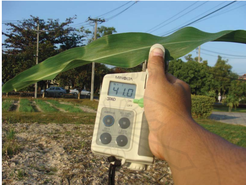
ภาพที่ 10 แสดงเครื่องมือคลอโรฟิลล์มิเตอร์ (SPAD-502) และลักษณะการใช้งาน
