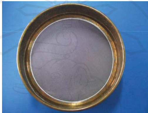
ภาพ 1 ตะแกรงที่ใช้ร่อนไข่มอดแป้ง ขนาดช่อง 250 ไมโครเมตร
