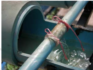
รูป 6 ผ้ากรองสปอร์ขนาด 20 \mu\text{m} . ที่ใช้ในระบบ NFT
