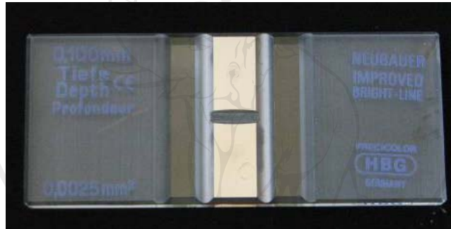
ภาพผนวกที่ 1 เครื่องมือวัดความเข้มข้น (Haemocytometer)
