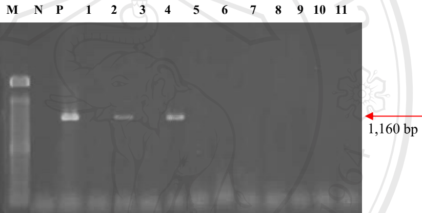
ภาพที่ 8 แถบดีเอ็นเอของ greening organism บน 1% agarose gel
