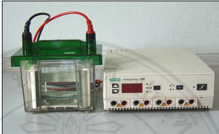
รูป 2 ชุดอิเล็กโทรโฟรีซิส แบบ Mini Protein II ของ BIORAD
