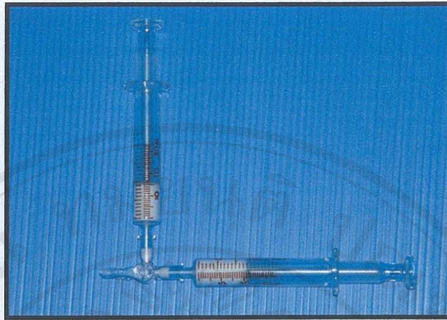
ภาพที่ 3-1. แสดงอุปกรณ์ไฮโมจิไนซ์เพื่อเตรียมแอนติเจนในการกระตุ้น.
