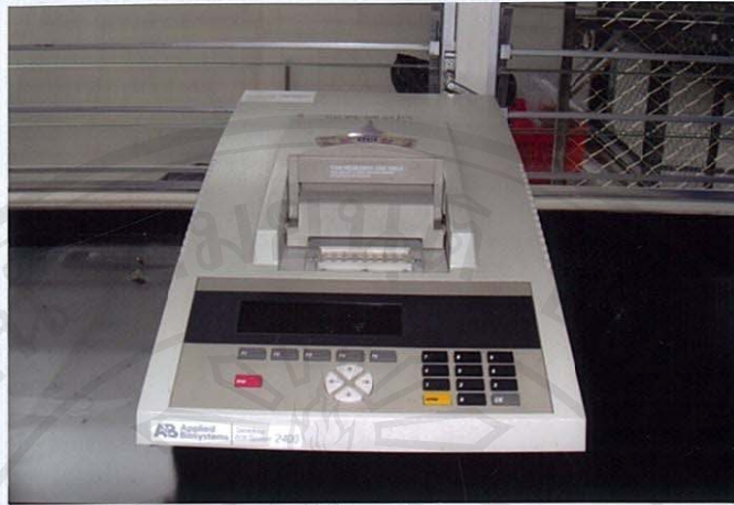
ภาพ 2 เครื่อง thermocycler ควบคุมปฏิกิริยา PCR
