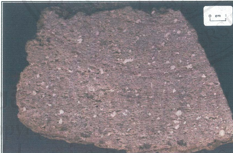
ภาพที่ 11 หินพัมมิชเขาพนมฉัตร ตัดเป็นแผ่น แสดงเส้นใยที่ประกอบด้วยแก้วภูเขาไฟ และช่องว่างระหว่างเส้นใย ซึ่งเกิดจากแก๊สต่างๆ และไอน้ำที่ระเหยหายไป จุดสีขาว คือ แร่ Plagioclase feldspar (สิโรตม์, ม.ป.ป.)
