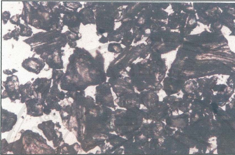
ภาพที่ 12 แก้วภูเขาไฟ (ขยาย 70 เท่า) แสดงรูซึ่งเป็นท่อขนาดเล็ก
