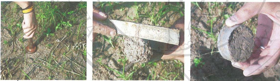
ภาพที่ 23 แสดงการเก็บตัวอย่างดินเพื่อทำการหาความหนาแน่นรวม และความพรุน
