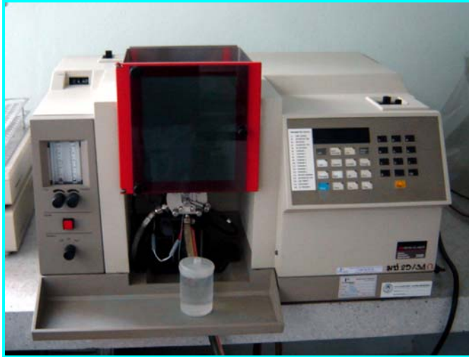
ภาพที่ 4 เครื่อง Atomic absorption spectrophotometer ของบริษัท PERKIN ELMER รุ่น 3100
