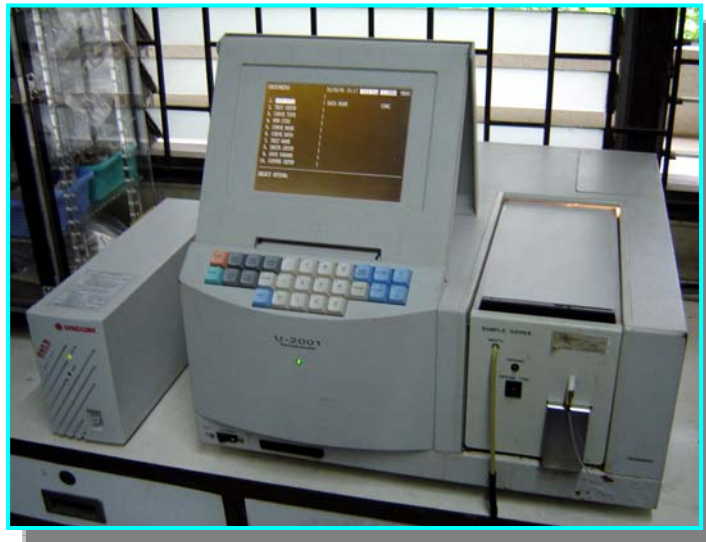
ภาพที่ 3 เครื่องวัดค่าการดูดกลืนแสง (Spectrophotometer) ของบริษัท HITACHI รุ่น U-2001
